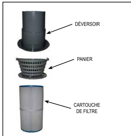
4. Rincez la cartouche à l'aide d'un tuyau d'arrosage. Faites tourner les plis du filtre, et séparez-le lorsque vous les arrosez d'eau afin de retirer tous les débris. Laissez le filtre sécher, puis vérifiez qu'il n'y a pas de dépôt de calcium (tartre) ni de pellicule d'huile. Si vous en trouvez, nettoyez la cartouche de filtre avec une solution de nettoyage pour filtres de spa afin de détacher et de supprimer les dépôts minéraux et les huiles.
