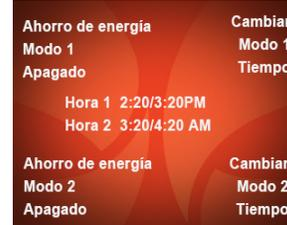
Este modo le permite ahorrar energía apagando la calefacción en dos momentos predeterminados del día durante un máximo de 6 horas en cada configuración.
