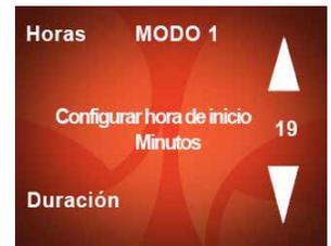
Pulse el botón en pantalla junto a **Duración** para configurar las horas que desea que esté funcione el modo ahorro de energía.
