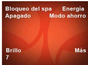
Una vez activado, la función de bloqueo del spa desactiva todas las funciones de los paneles de control. Evita que los demás alteren las configuraciones de los jets, las luces y la temperatura en su spa. El panel de control no responde a ninguno de los botones duros ni en pantalla al pulsarse en el modo de bloqueo del spa.
