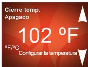
La temperatura del agua del spa se establece automáticamente a 100 °F (38 °C) la primera vez que se aplica la energía. Ésta es la configuración programada en la fábrica. Después de instalar y utilizar el spa, el último valor de temperatura ajustado por el usuario quedará guardado en la memoria. Si desconecta el spa del suministro eléctrico, cuando se vuelva a conectar volverá automáticamente a la última temperatura establecida.
