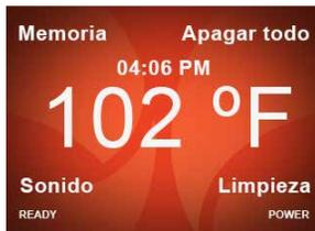
La temperatura mostrada en el centro de la pantalla de inicio es la temperatura actual del agua del spa. Si se visualiza el indicador de READY y permanece en el panel de control, es que la temperatura actual del spa está dentro de los 2°F (1°C) de temperatura ajustada. Las funciones del botón en pantalla de la esquina son las siguientes:
